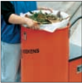
Toepassing van de PNV-filterzak in combinatie met een vliso wegwerpzak die tegelijkertijd als voorfilter dient.
