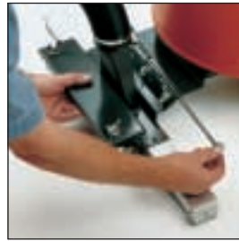
Voor grote vloeroppervlakken kan een vaste vloerzuigmond worden gemonteerd.
